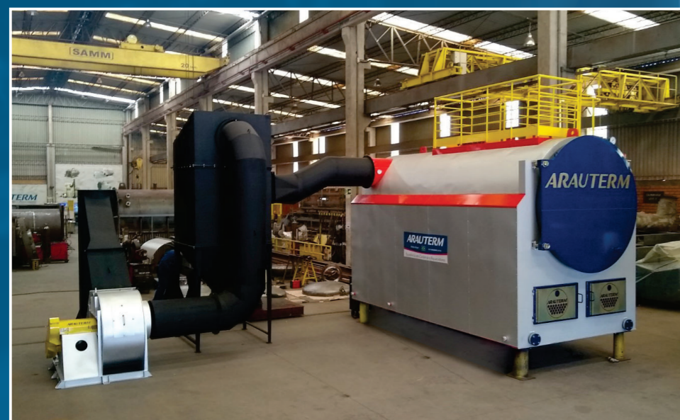
Pré-montagem caldeira CVS-IL-5000 dentro da fábrica da Arauterm
